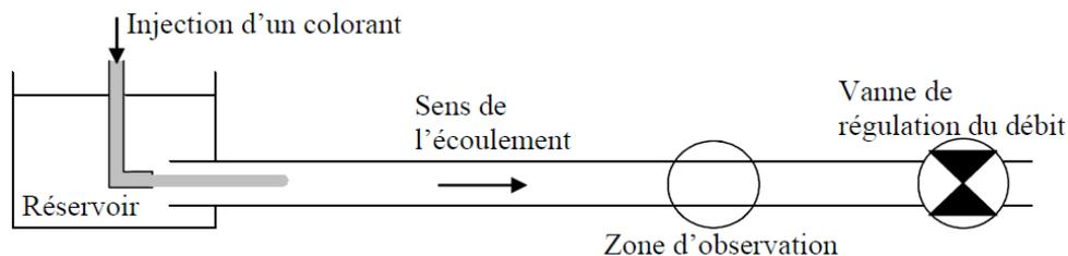
Un premier réservoir d'eau de niveau constant est vidangé par un conduit. Une vanne placée à l'extrémité du conduit permet de faire varier le débit. Un tuyau placé à l'intérieur du réservoir permet d'injecter un mince filet fluide coloré au centre du conduit.
